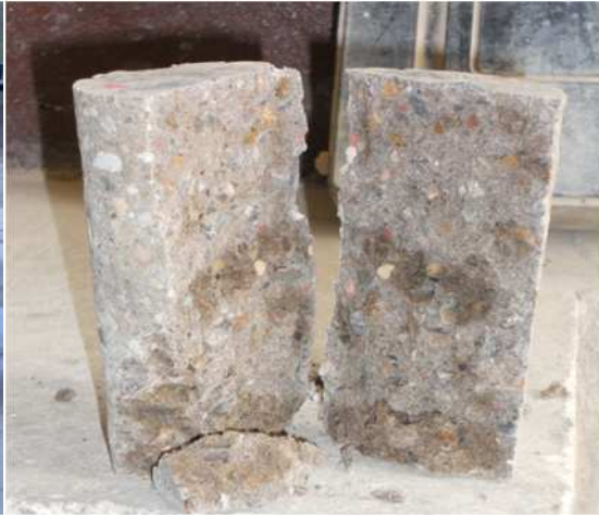
ENSAYO A COMPRESIÓN DE NÚCLEOS
