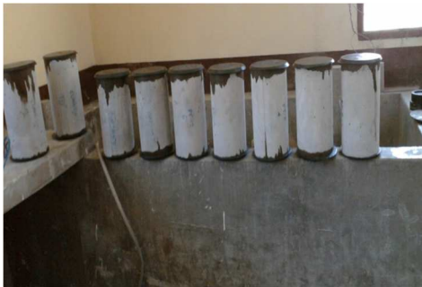
Foto N° 8 Ensayos a compresión Hormigones de Cunetas y Bajantes Estribo Izquierdo.
