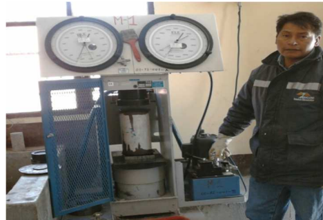
Foto N° 8 Ensayos a compresión Hormigones de Cunetas y Bajantes Estribo Izquierdo.
