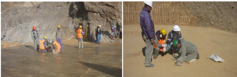
Foto N° 5 Ensayo de Densidades zona 1A
