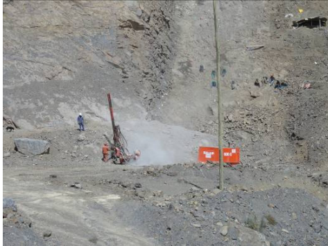
Foto 5: Perforación para voladura - cota 3666
