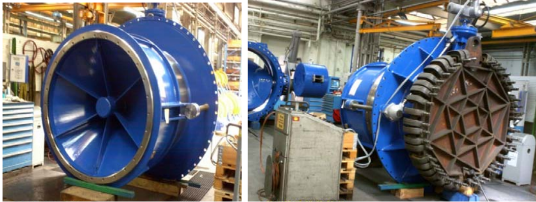
Válvula Howell Bungler en prueba de presión hidrostática
