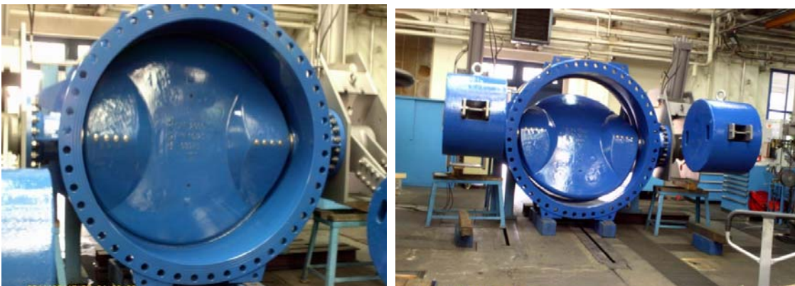
Válvula mariposa cerrada (vista de aguas arriba)
