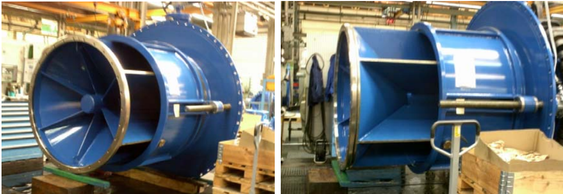
Válvula dispersora en posición de abertura parcial
