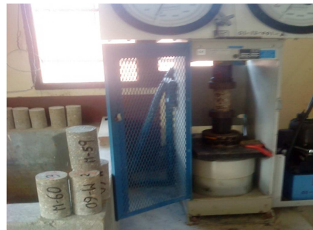
FOTO N 5 ENSAYO A COMPRESION DE NUCLEOS
