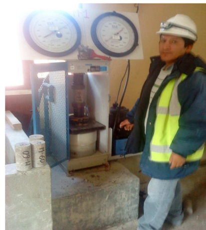
FOTO N° 7 ENSAYO A COMPRESION DE NUCLEOS
