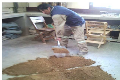
Foto N° 4 Toma de densidades, Relleno de material sector Ataguía (1-A).
