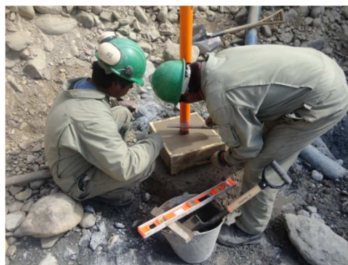
Foto N° 42 Placa de asentamiento 1 en el medidor MM-3
