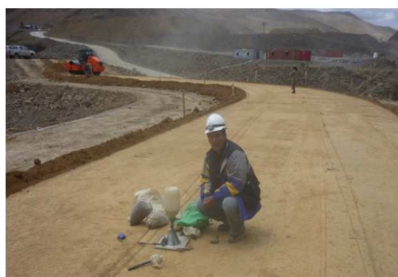
Foto N° 4 Toma de densidades, Relleno de material sector Ataguía (1-A).
