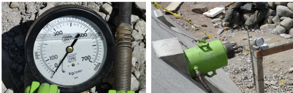
Foto N°24.- Manómetro y Gato hidráulico utilizado durante las pruebas
