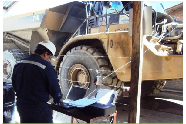
Personal especializado realizando el control de la emisión de gases de combustión
