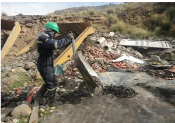
Obrero haciendo el retiro manual de un derrame
