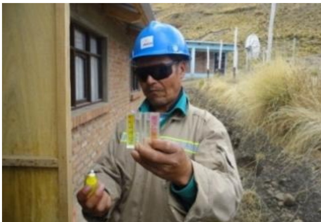
Muestras para control de dosificación de cloro
