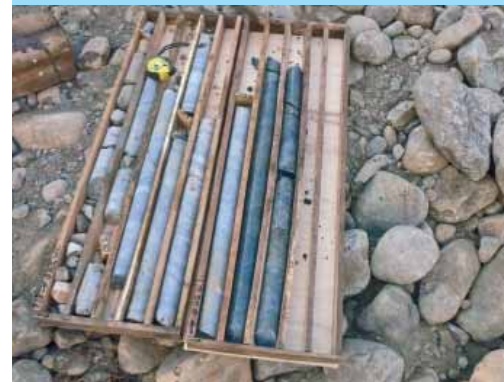
Muestras de sondeo S-101, calidad de roca al nivel del portal de entrada
